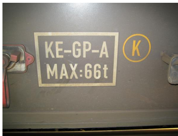
Figure 2 – Exemple de cartouche d'un wagon
